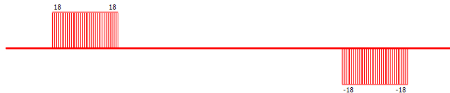
Эпюра изгибающих моментов, [т*м] (расчетные нагрузки)
