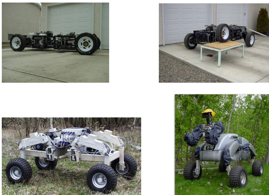
Рис.1. Примеры гибридных мобильных роботов. Zanthic и WorkPartner
